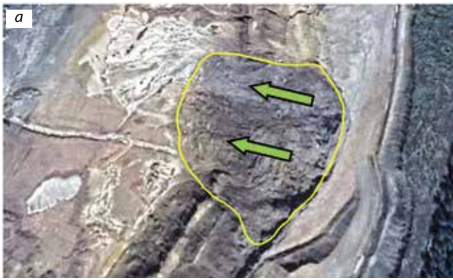
Рис. 1. Деформации бортов карьеров (на снимках из космоса): а – в массиве горных пород с низкими прочностными характеристиками; б – в массиве на контакте горных пород с различающимися прочностными характеристиками
