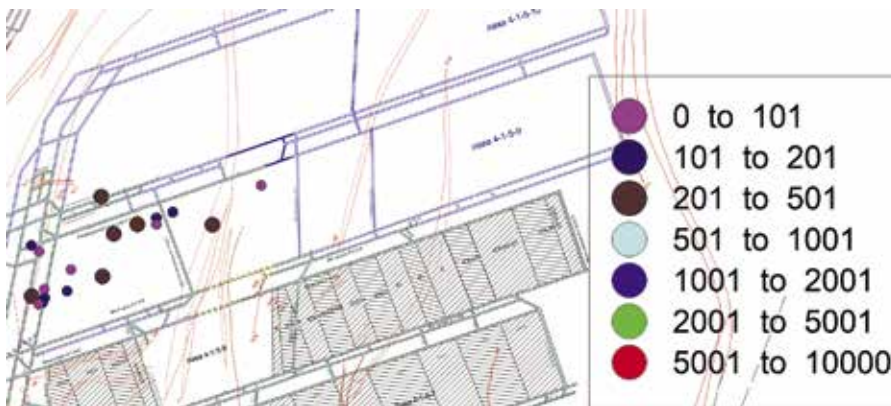
Рис. 2. Гипоцентры сейсмических событий (в плане), зарегистрированных в проекции трасс проведения подготовительных выработок (III кв. 2023 г.)
