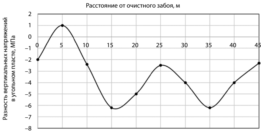
Рис. 4. График изменения вертикальных напряжений в зоне опорного горного давления впереди лавы под влиянием сейсмической волны при технологическом взрыве, МПа
