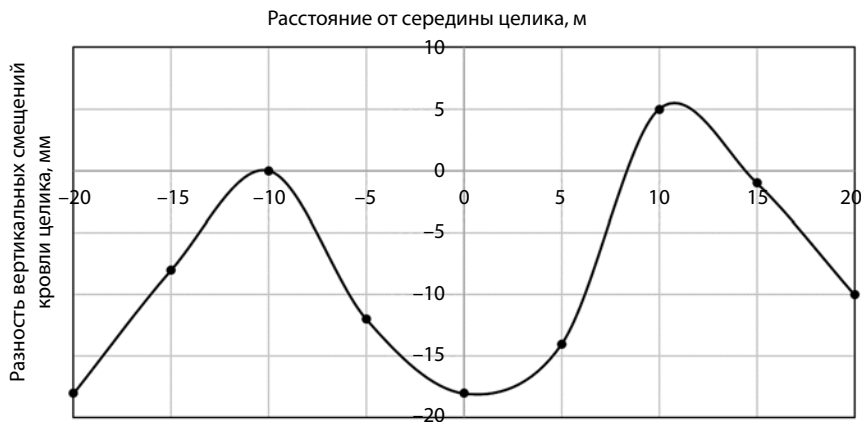
Рис. 3. График изменения вертикальных смещений пород под влиянием сейсмической волны при технологическом взрыве на угольном разрезе, мм
