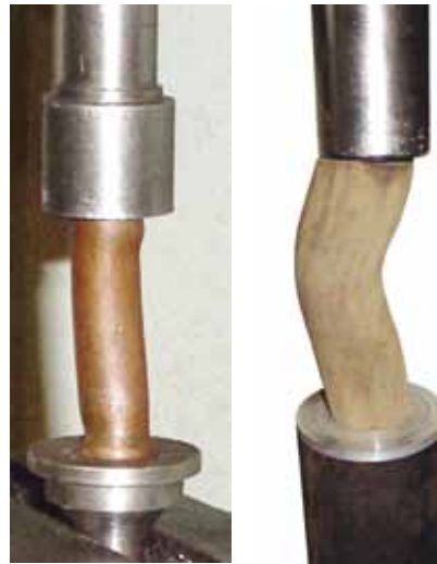
Рис. 2. Потеря устойчивости элементов при осевом сжатии: а – металлическая оболочка; б – полиуретановая Fig. 2. Loss of element stability under axial compression: a – a metal shell; b – a polyurethane shell
