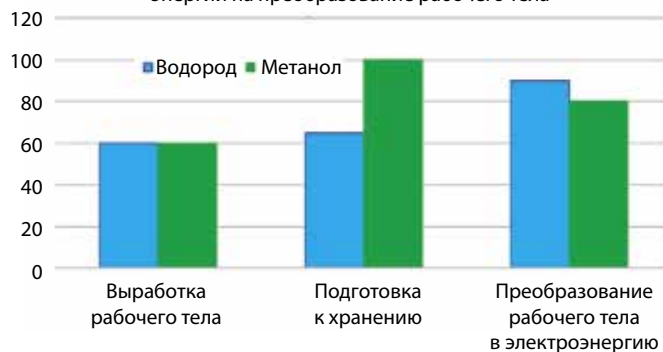
Рис. 2. Эффективность процессов преобразования водорода и метанола при накоплении энергии
