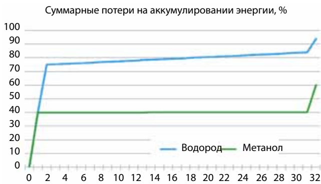
Рис. 3. Суммарные потери при использовании водорода и метанола в качестве рабочего тела для аккумуляции энергии с ВИЭ
