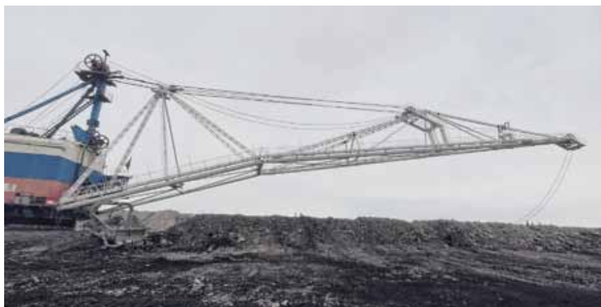
Рис. 1. Процесс опускания стрелы экскаватора ЭШ 10/70 Fig. 1. The process of lowering the boom of the ASh 10/70 excavator
