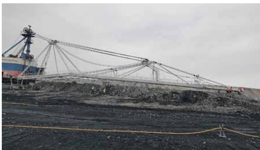
Рис. 2. Выкладка стрелы на земляной вал и деревянные шпалы Fig. 2. Laying out the boom on the earthen rampart and wooden sleepers
