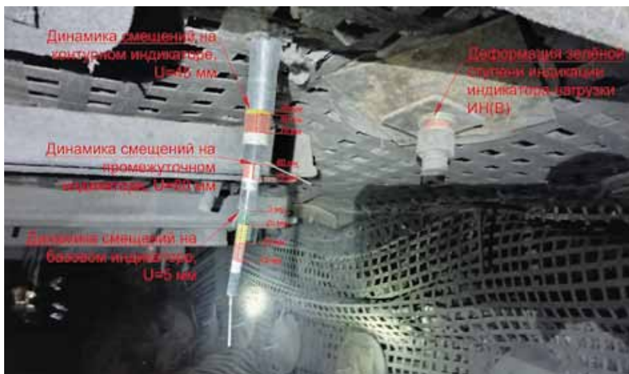
Рис. 5. Смещения на контурном и промежуточном индикаторах смещения и деформация зеленой ступени индикации на индикаторе нагрузки ИН(В) Fig. 5. Displacements on the edge and intermediate displacement indicators, and deformation of the green indication stage on the IN(V) load indicator
