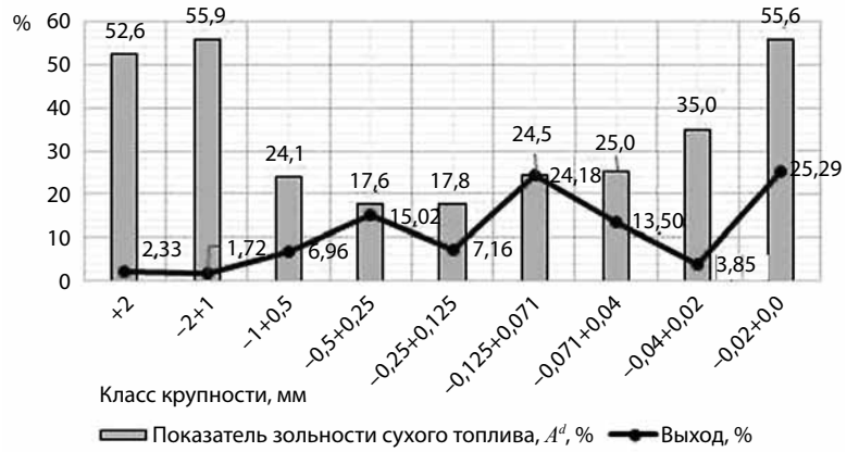
Рис. 1. Гранулометрический анализ исходного сырья с показателями зольности сухого топлива в каждом классе крупности лежалых хвостов ОФ «Прокопьевскуголь»
