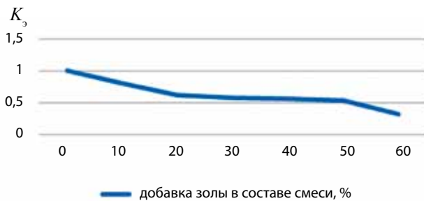
Определение коэффициента цементующей эффективности при вводе золы-уноса в состав смеси Determination of the cementing efficiency index when fly ash is introduced into the mixture
