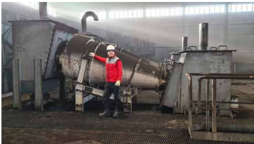
Тяжелосредний гидроциклон диаметром 1150 мм
