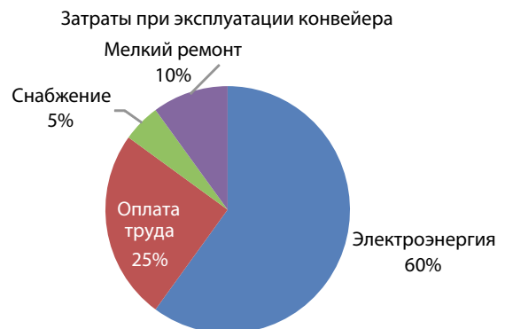
Рис. 4. Доли затрат при эксплуатации наклонного конвейера
