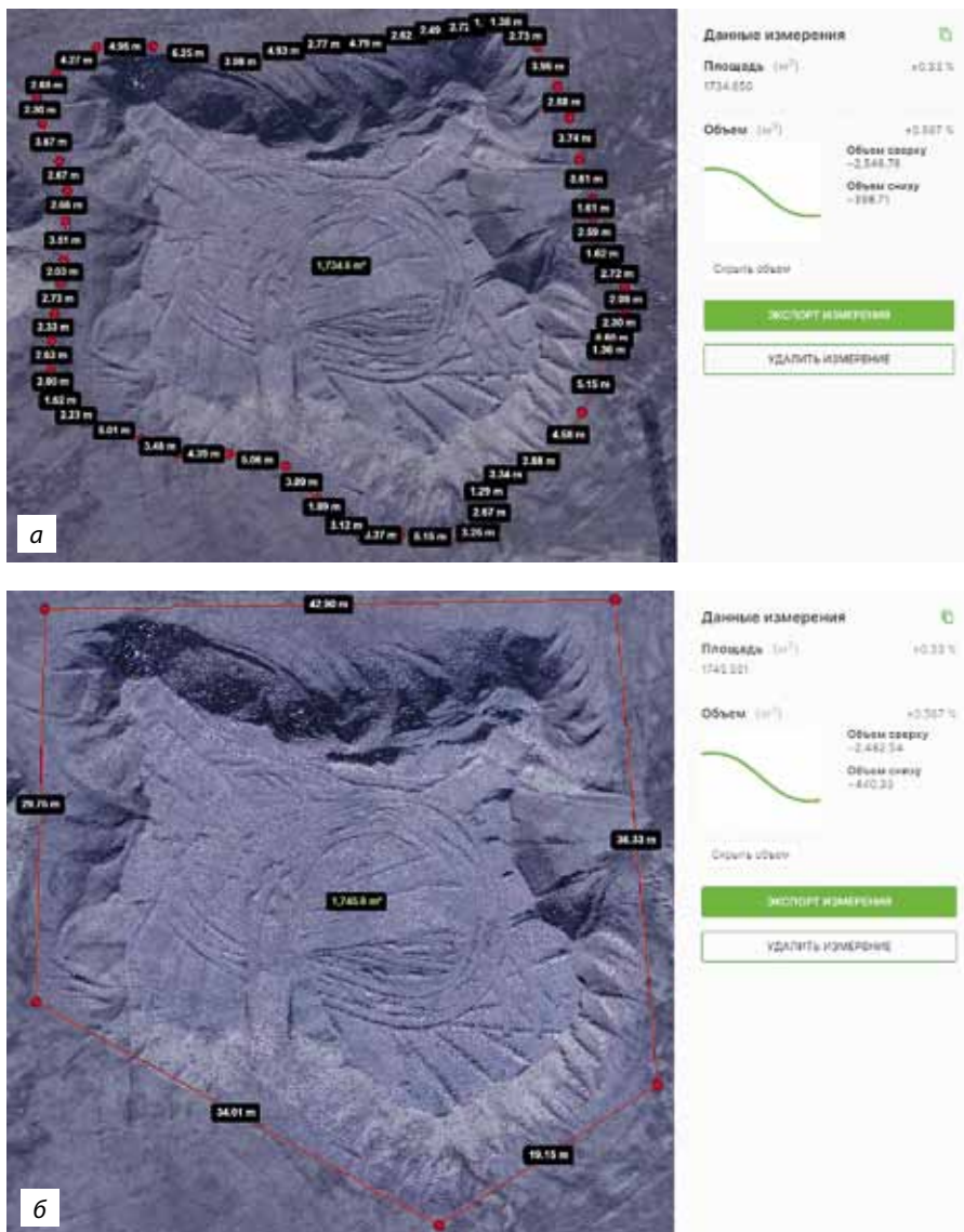
Рис. 4. Пример расчета объема склада № 2000 при разной степени детализации границ: а – расчет объема при высокой детализации границ, б – расчет объема при ограниченной детализации границ
