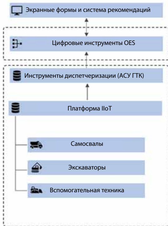
Рис. 6. Система цифрового мониторинга и оперативного управления процессами
