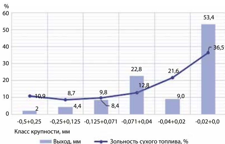
Рис.4. Данные гранулометрического анализа угольного концентрата с показателями зольности в каждом классе крупности
