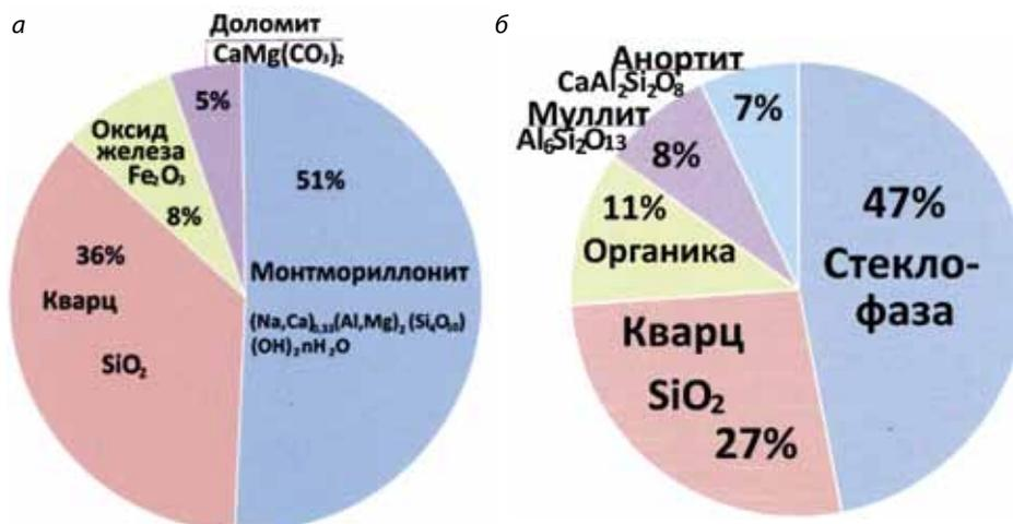
Рис. 2. Минералогический состав сырьевых компонентов: а – монтмориллонитовая глина; б – золошлаковый материал
