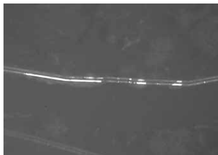
Рис. 4. Пример тепловизионного снимка трубопровода с дефектами изоляции, требующими ремонта
