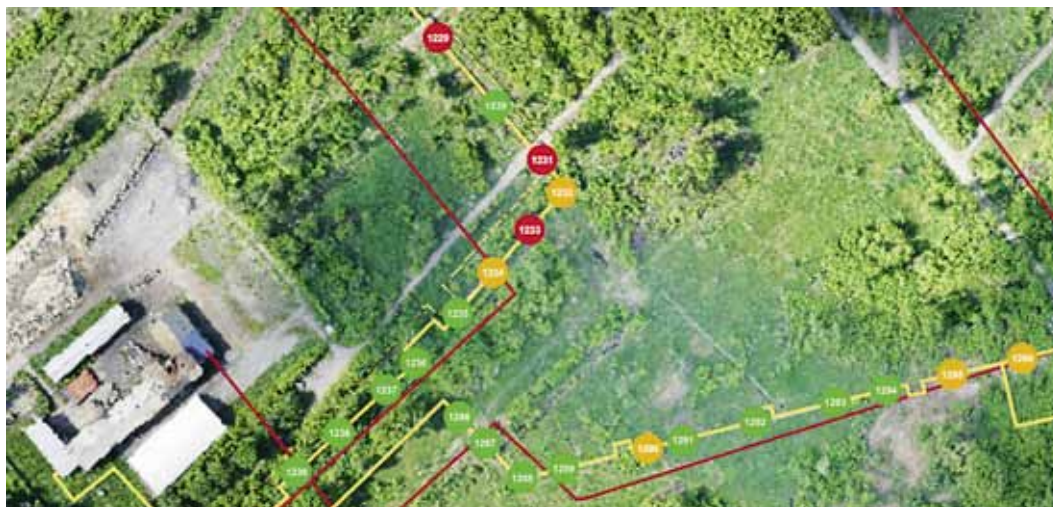
Рис. 1. Пример ортофотоплана с фиксацией положения участка тепловой сети
