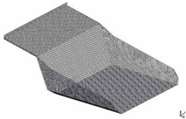
Рис. 3. Общий вид модели грузовой платформы карьерного самосвала БелАЗ 7530
