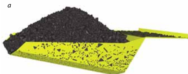
Рис. 6. Сравнение полученной геометрии шапки модели (а) и фактической геометрии (б) в грузовой платформе карьерного самосвала БелАЗ 7530
