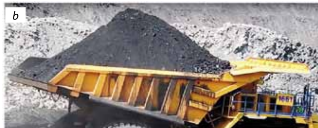
Рис. 6. Сравнение полученной геометрии шапки модели (а) и фактической геометрии (б) в грузовой платформе карьерного самосвала БелАЗ 7530
