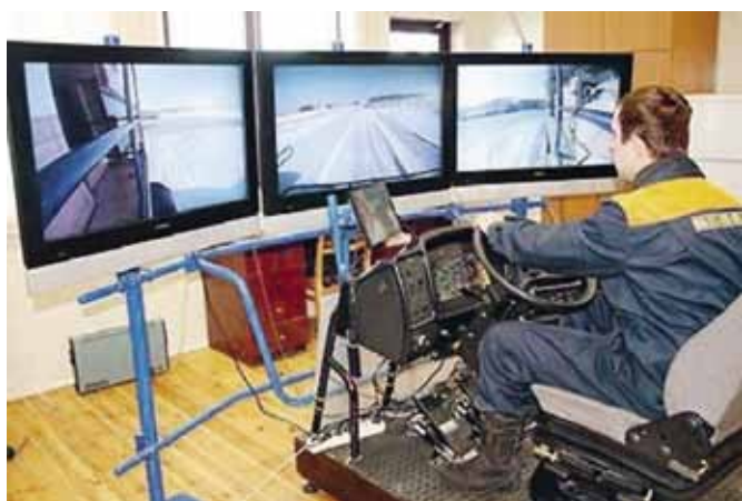
Рис. 2. Организация АРМ оператора на примере разработки БЕЛАЗ
