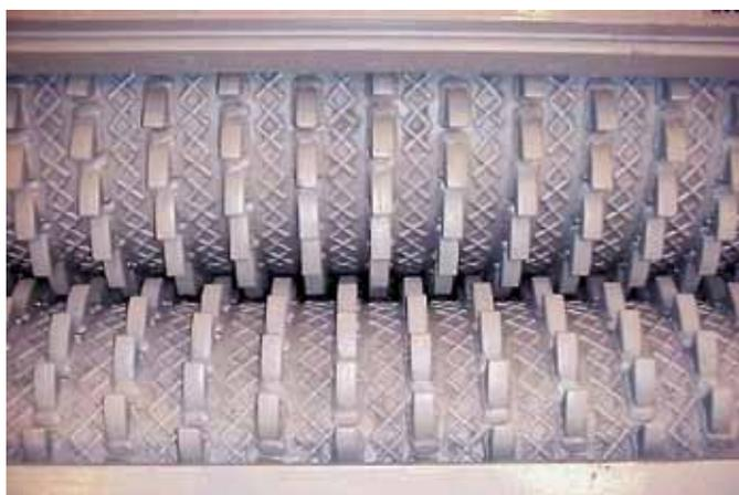
Рис.1. Вид зубчатых валков в корпусе двухвалковой дробилки среднего дробления
