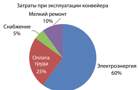
Рис. 4. Доли затрат при эксплуатации наклонного конвейера
