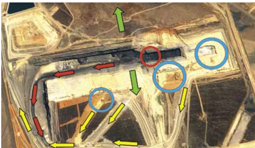
Горные работы на месторождении каменного угля в «малом карьере» с протяженностью фронта 1,0 км на территории Южно-Африканской Республики (на снимке из космоса)
