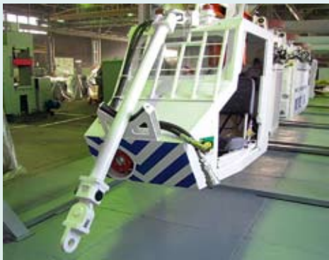
Шахтный подвешной дизельный локомотив BEVEX 80R в сборочном цехе компании ООО «Сибэлектро» (г. Новокузнецк)
